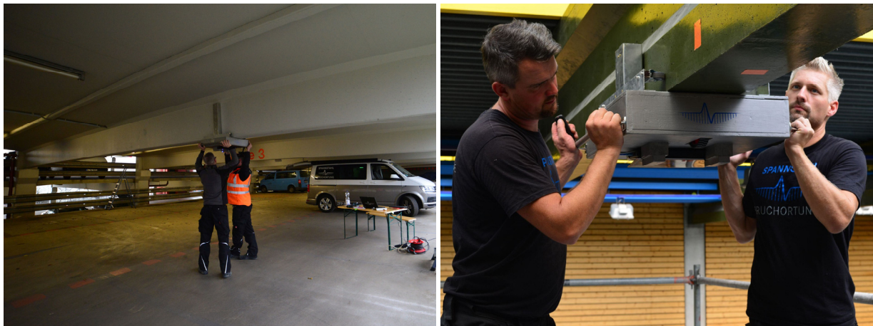
Bild 4: Untersuchung von Spannbetonträgern mit der U-Sensoreinheit
